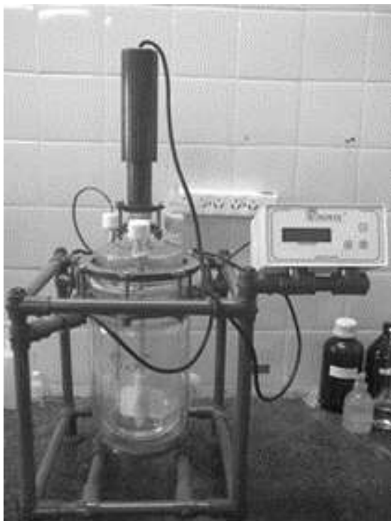
Figura 1. Bioreactor para ensayos de laboratorio
