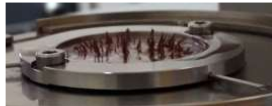
Figura 10 a: Imagen ampliada de las partículas PM en el fluido MMPM
