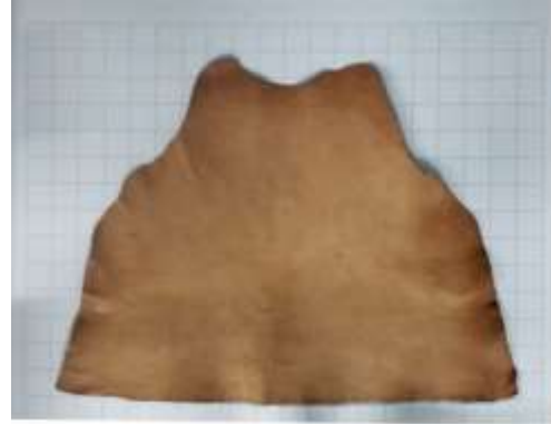
Figura 2: Pieza de cuero ubicada sobre la rejilla para la determinación manual del área.
